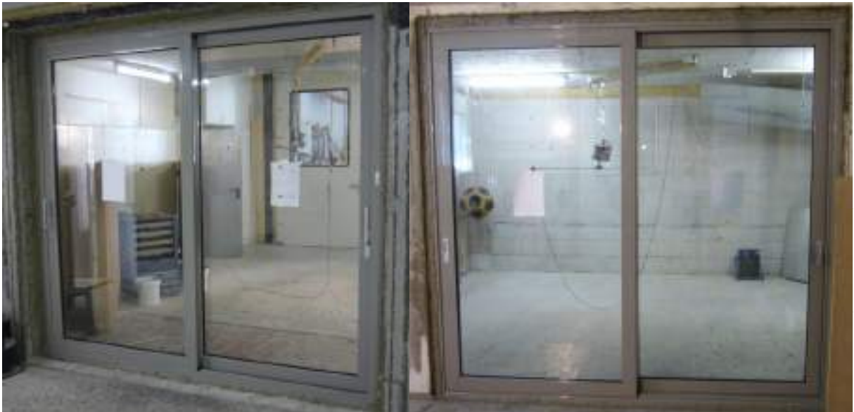
Bild 1 Fotos des eingebauten Elementes, links vom Empfangsraum aus, rechts vom Senderraum aus, erstellt vom ift Schallschutzzentrum
